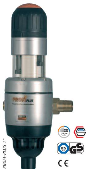
Le PROFI-PLUS protège effectivement et économiquement les conduites d'eau, les robinets et les appareils raccordés. Dans le PROFI-PLUS l'eau est filtrée de l'extérieur vers l'intérieur et les impuretés sont retenues. On peut contrôler l'état du tamis par la cloche translucide. Le nettoyage se fait par aspiration, le rétrolavage est actionné par une simple manipulation.
